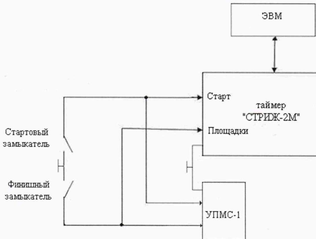
Рисунок 1 - Схема измерений при определении абсолютной погрешности измерений интервалов времени
