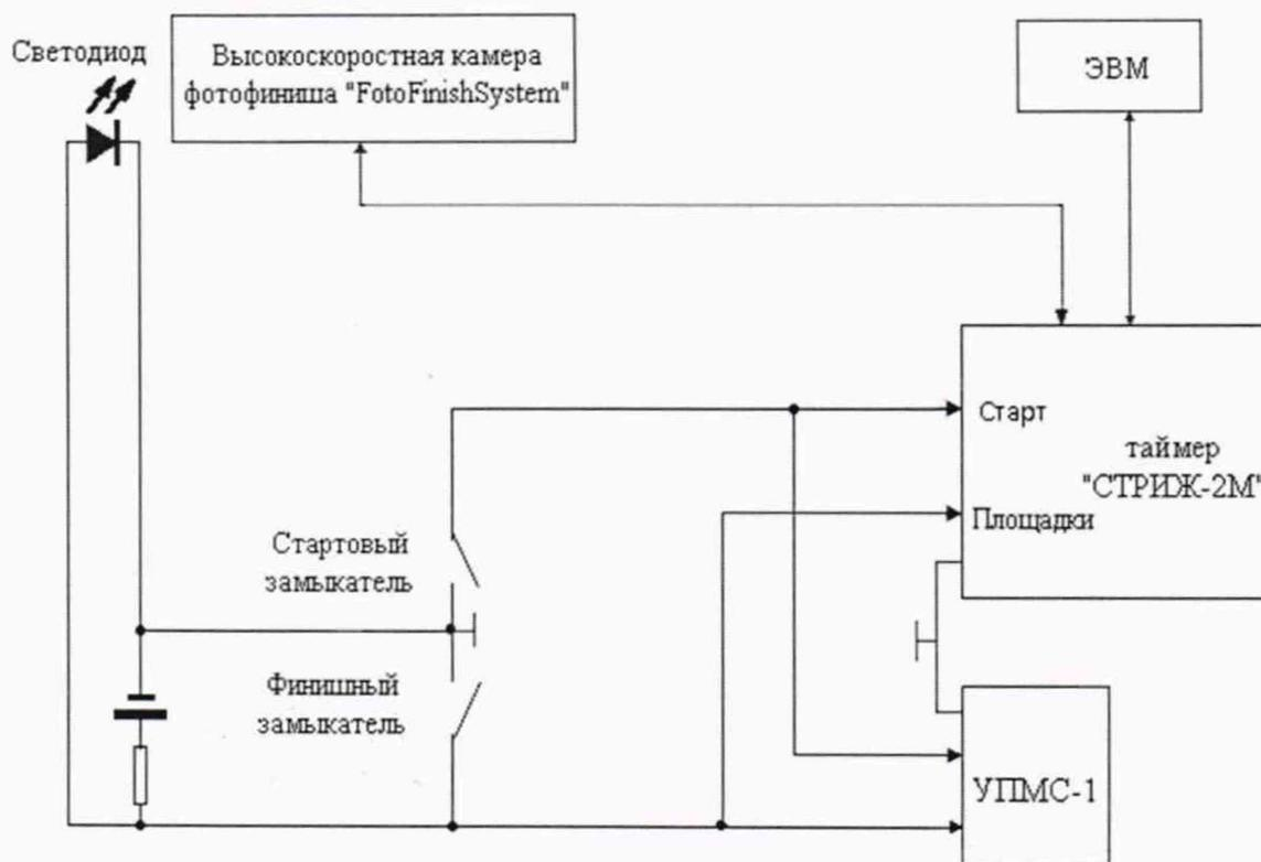
Рисунок 2 - Подключение высокоскоростной камеры для проведения поверки
