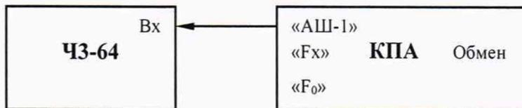
Рисунок 1. Схема подключения для проверки номинального значения частоты выходного сигнала
