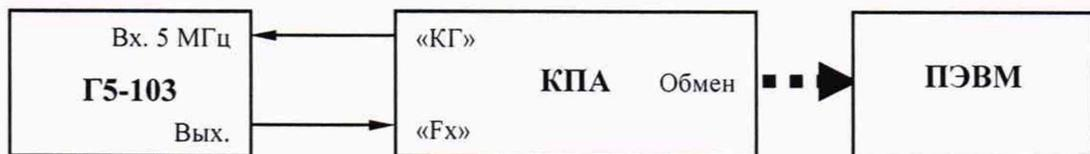
Рисунок 2. Схема подключения для проверки средней квадратической относительной погрешности измерений частоты импульсного сигнала
