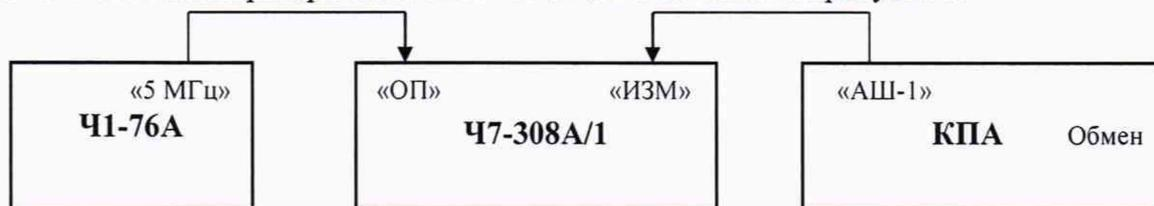
Рисунок 3 Схема подключения проверки среднего относительного изменения частоты
