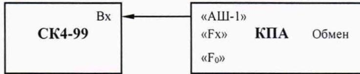
Рисунок 9. Схема подключения для проверки уровня гармонических составляющих в спектре выходного сигнала (относительно сигнала частотой 5 МГц)
