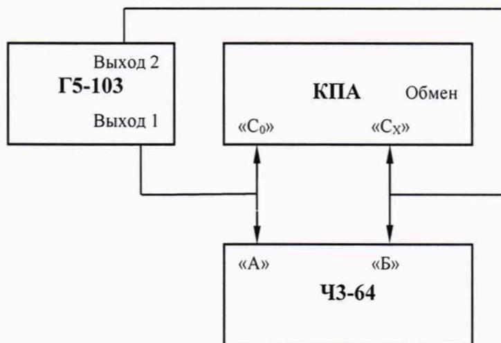
Рисунок 6 Схема подключения проверки абсолютной погрешности измерений длительности задержки импульсов
