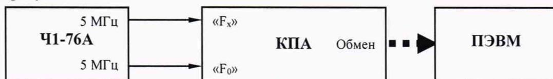
Рисунок 4. Схема подключения для проверки средней квадратической относительной погрешности измерений частоты сигнала 5 МГц
