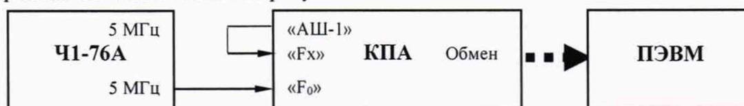
Рисунок 7. Схема подключения для проверки спектральной плотности мощности собственных фазовых шумов в одной боковой спектра сигнала на частоте несущей 5 МГц
