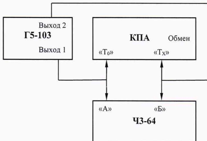
Рисунок 5 Схема подключения проверки средней квадратической погрешности измерений длительности
