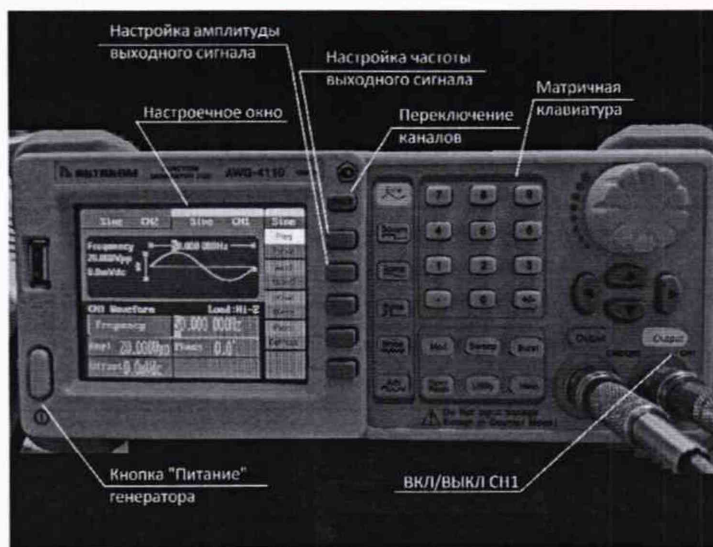
Рисунок 6 – Настройка CH1 в качестве источника напряжения синусоидальной формы частотой 50 Гц
