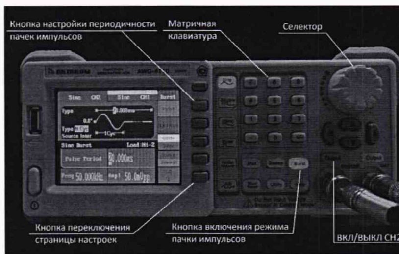
Рисунок 15 – Настройка режима выдачи пачек импульсов (ч.1)
