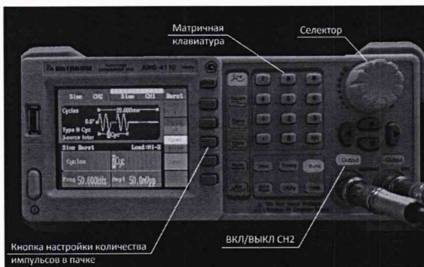
Рисунок 16 – Настройка режима выдачи пачек импульсов (ч.2)
