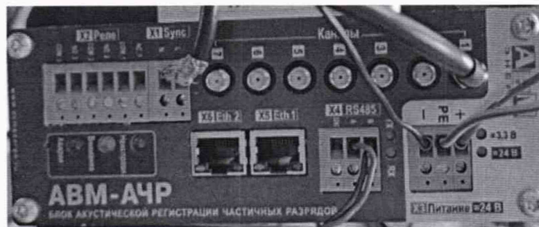
Рисунок 2 – Внешний вид блока после сборки схемы поверки
