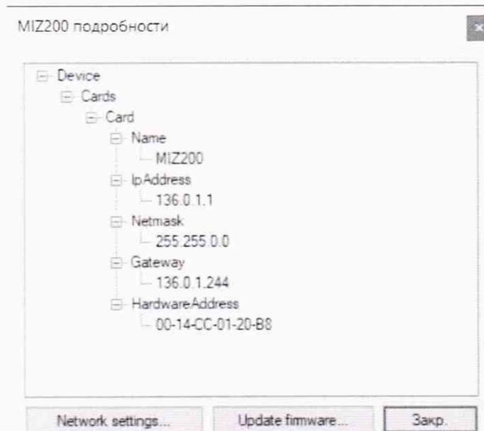
Рисунок 4 - IP-адрес и маска подсети дефектоскопа MIZ 200
