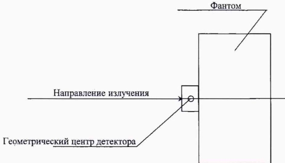
Рисунок 1 – Способ установки дозиметра с фантомом на поверочную дозиметрическую установку.
