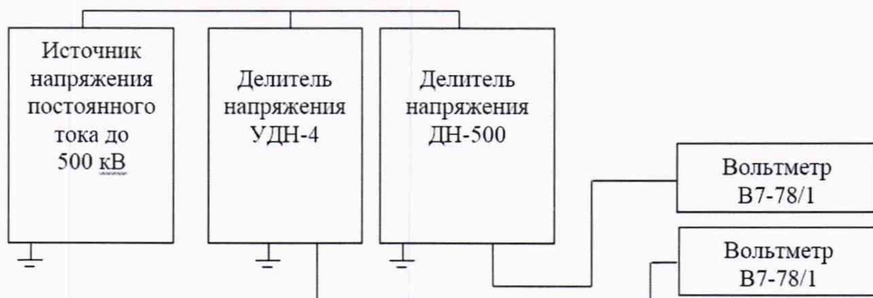
Рисунок 3 – Схема проверки погрешности преобразований напряжения постоянного тока
