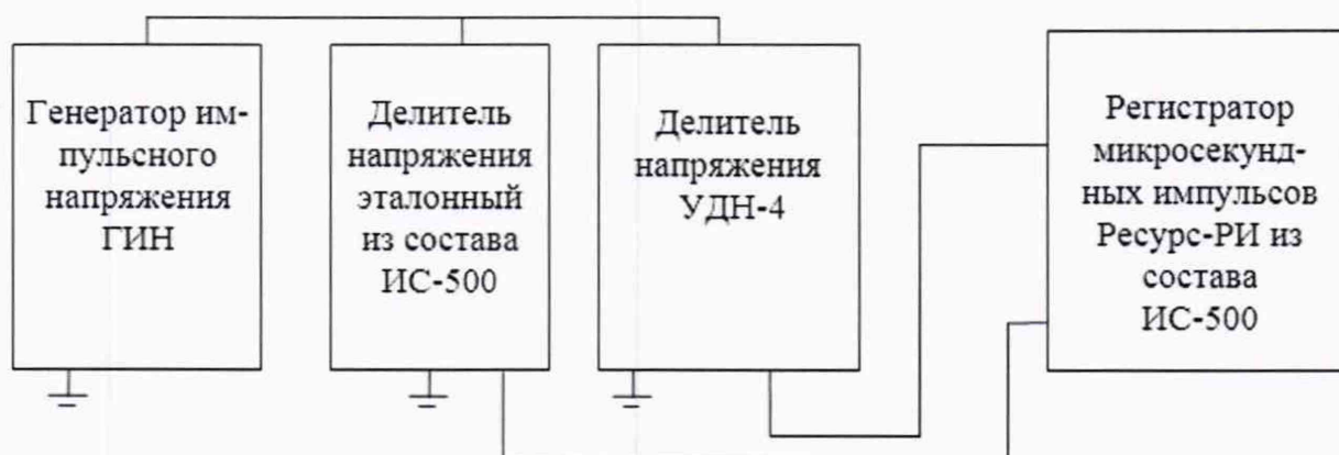
Рисунок 4 – Схема определения относительной погрешности преобразований напряжения стандартизованных коммутационных и грозовых импульсов
