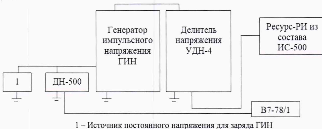
Рисунок 5 – Схема проверки линейности коэффициентов масштабного преобразования при работе на напряжении стандартизованных коммутационных и грозовых импульсов
