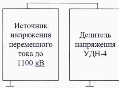
Рисунок 1 – Схема проверки электрической прочности
