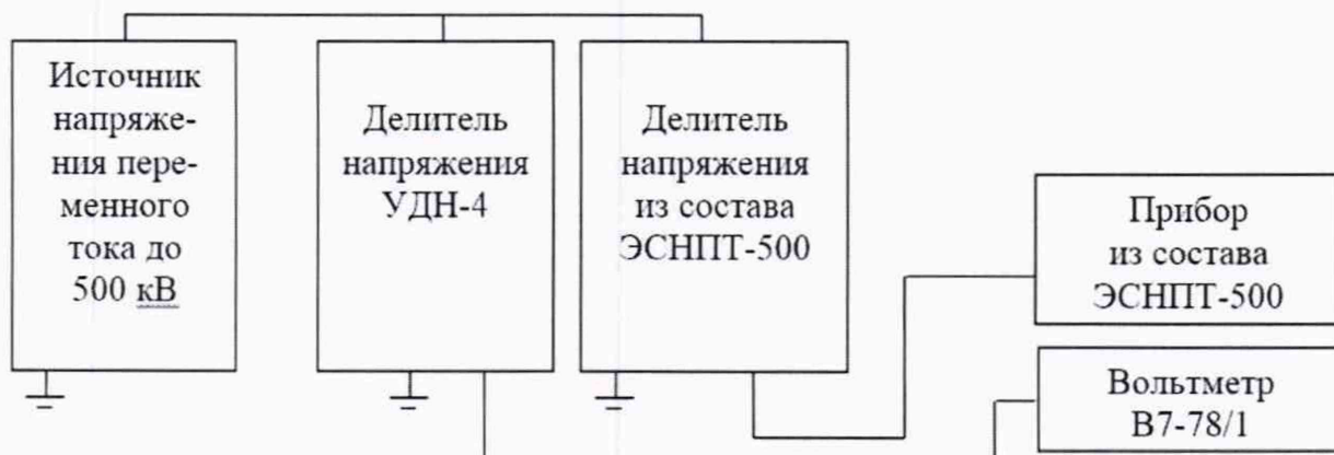
Рисунок 2 – Схема проверки погрешности преобразований напряжения переменного тока
