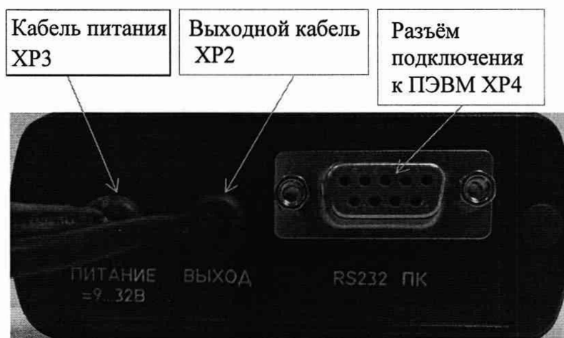
Рисунок 3.1. Передняя и задняя панели усилителя РШ2731Э85
