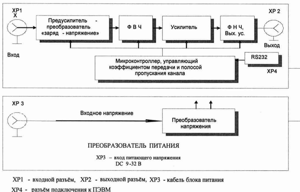
Рисунок 4.1 - Структурная схема взаимодействия составных частей РИИ2731Э85
