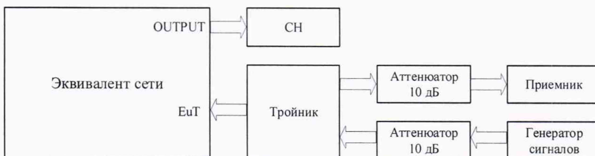
Рисунок 1 - Схема калибровки выходного уровня генератора сигналов
