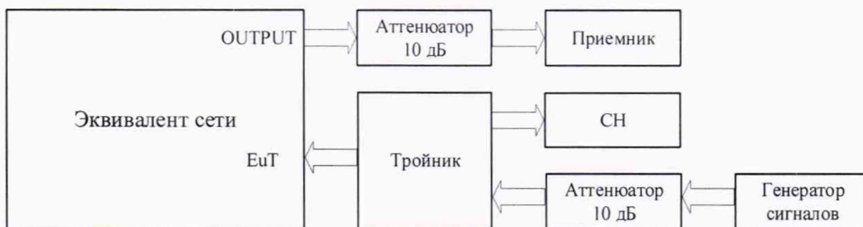
Рисунок 2 - Схема измерений выходного уровня эквивалента сети
