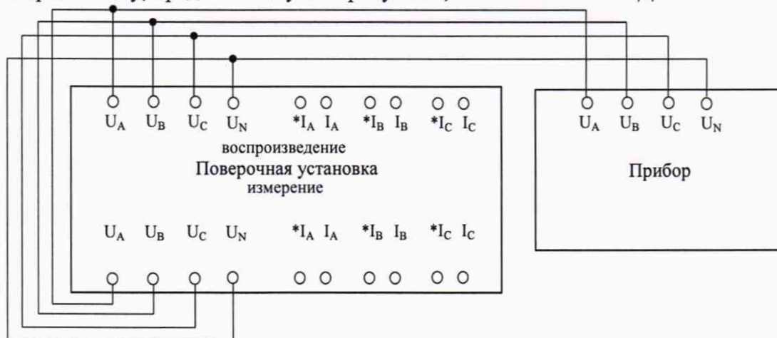
Рисунок 1 – Схема подключения при измерении напряжения переменного тока
