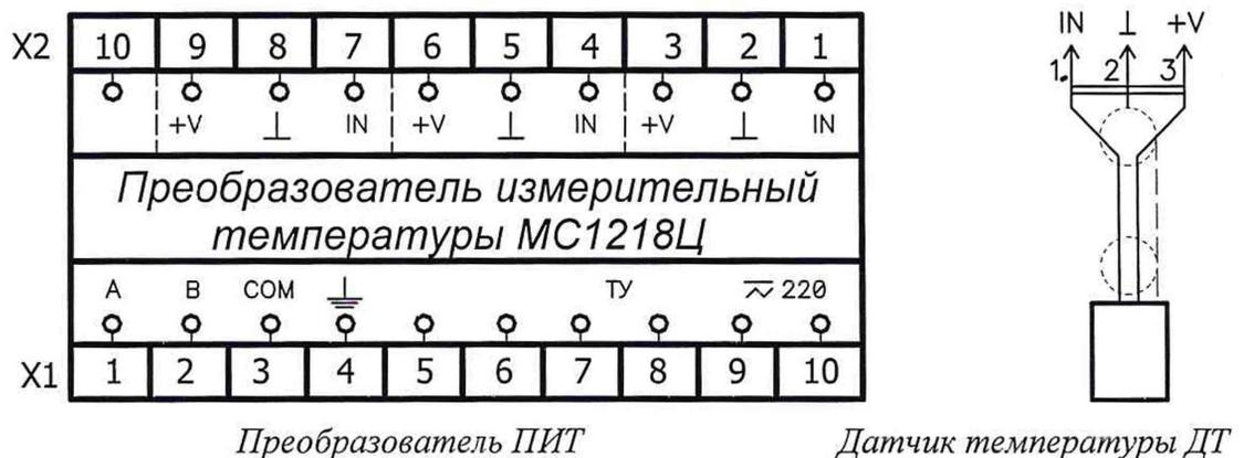
Рисунок 1 – Схема подключения (расположение выводов) преобразователя ПИТ и датчика температуры ДТ.
