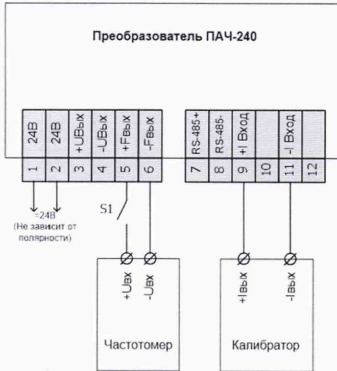
Рисунок А.1 – Схема подключения преобразователя и средств поверки при определении метрологических характеристик преобразователей по частотному выходу
