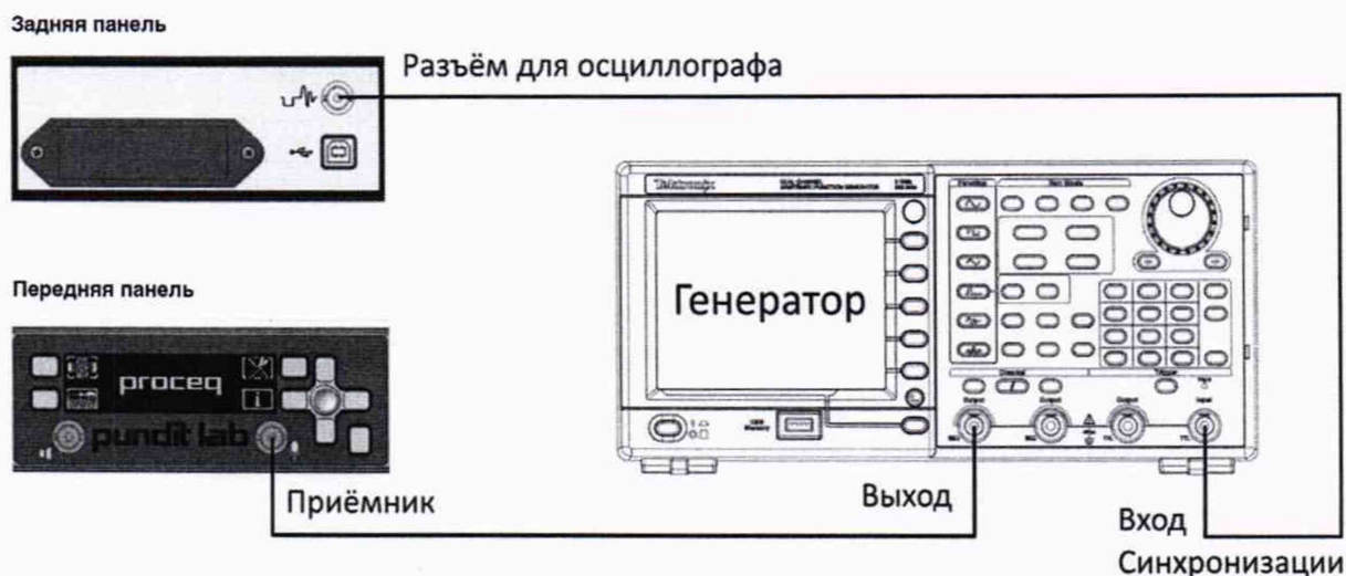
Рисунок 5 – Схема соединения для определения диапазона и абсолютной погрешности измерений времени распространения УЗК для прибора ультразвукового Pundit Lab+
