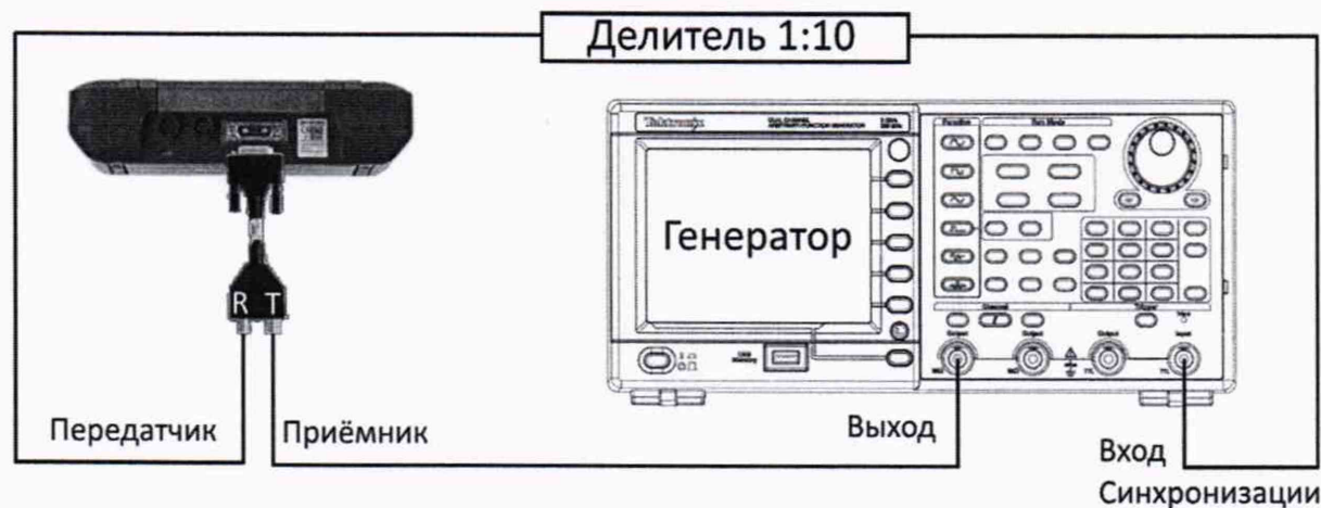
Рисунок 6 – Схема соединения для определения абсолютной погрешности измерений времени распространения УЗК для прибора ультразвукового Pundit PL-200
