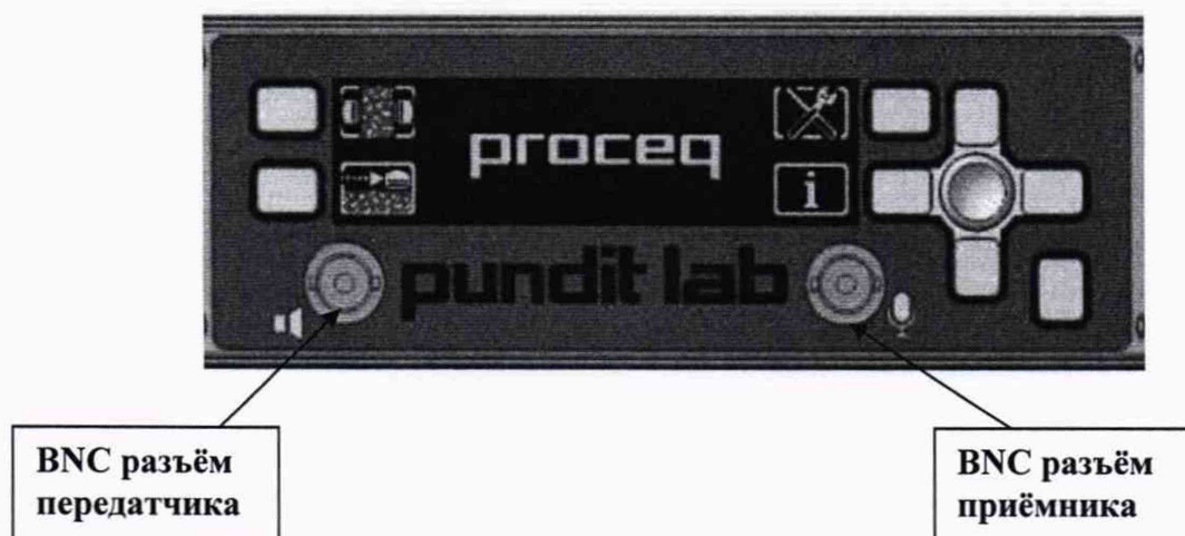
Рисунок 1 – Передняя панель прибора ультразвукового Pundit Lab+
