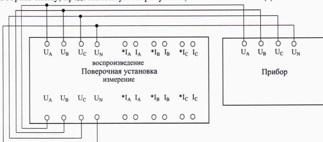
Рисунок 1 – Схема подключения при измерении напряжения переменного тока
