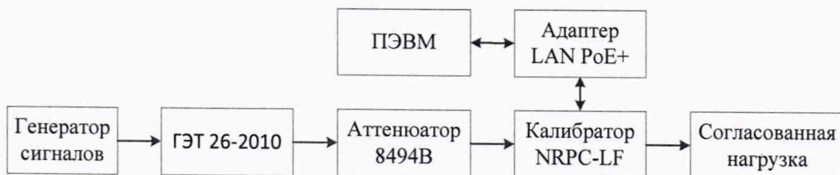
Рисунок 3 – Схема соединения приборов
