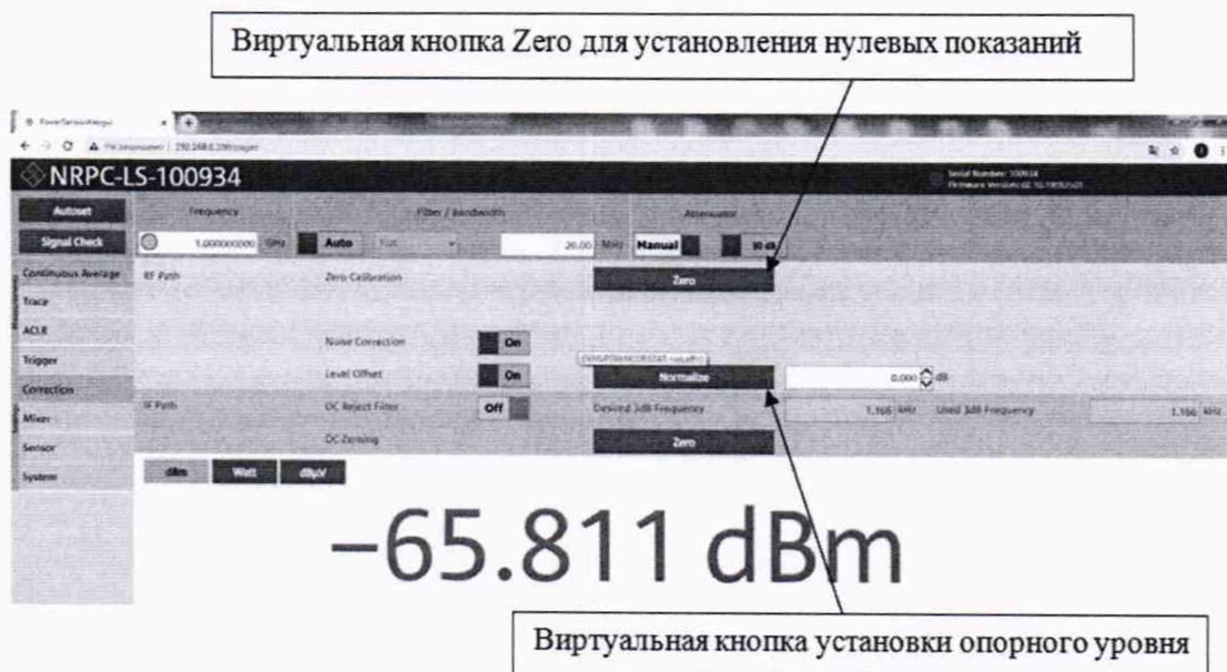
Рисунок 2 – Меню Correction страницы калибратора NRPC-LS
