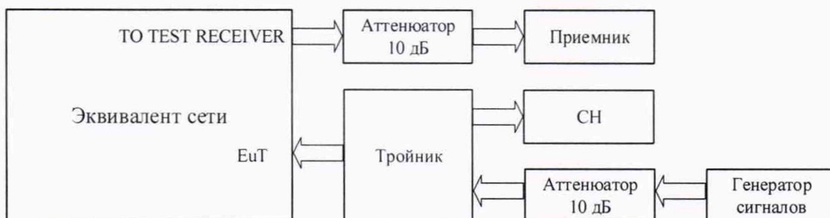
Рисунок 2 - Схема измерений выходного уровня эквивалента сети
