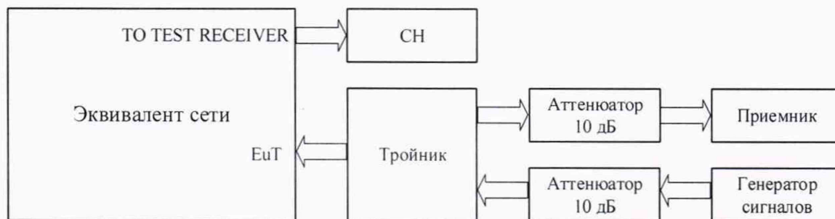
Рисунок 1 - Схема калибровки выходного уровня генератора сигналов
