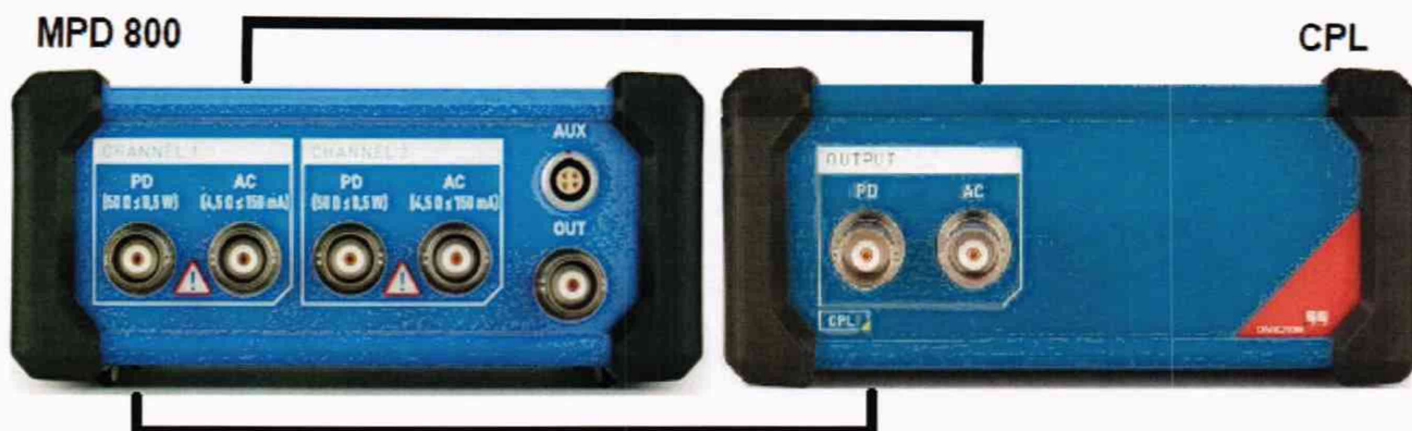
Рисунок 9 – Подключение устройства сопряжения CPL к устройству сбора данных ЧР MPD 800
