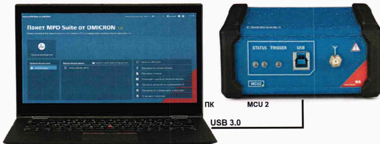
Рисунок 6 – Подключение ПК к контроллеру MCU 2 через USB 3.0
