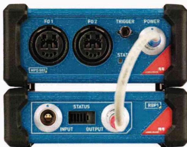
Рисунок 12 – Подключение аккумуляторного блока RBP1 к устройству сбора данных ЧР МРД 800
