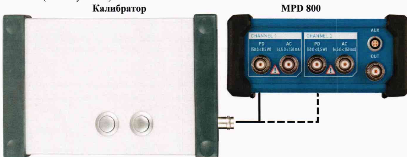
Рисунок 10 - Подключение калибратора к устройству сбора данных ЧР MPD 800
