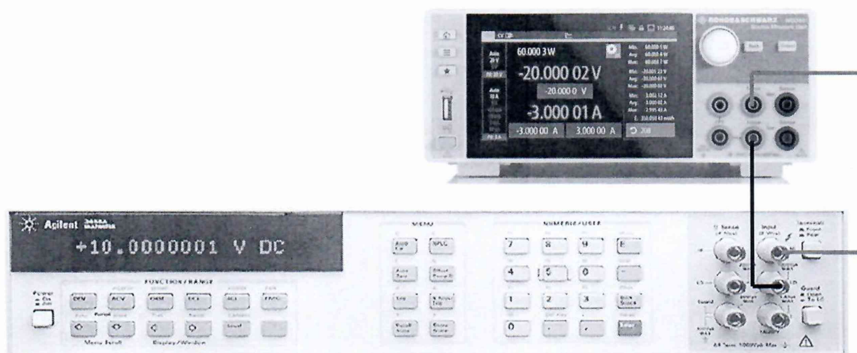
Рисунок 1 – Структурная схема соединения СИ для определения погрешности установки выходного напряжения постоянного тока и абсолютной погрешности измерений по встроенному индикатору выходного напряжения постоянного тока
