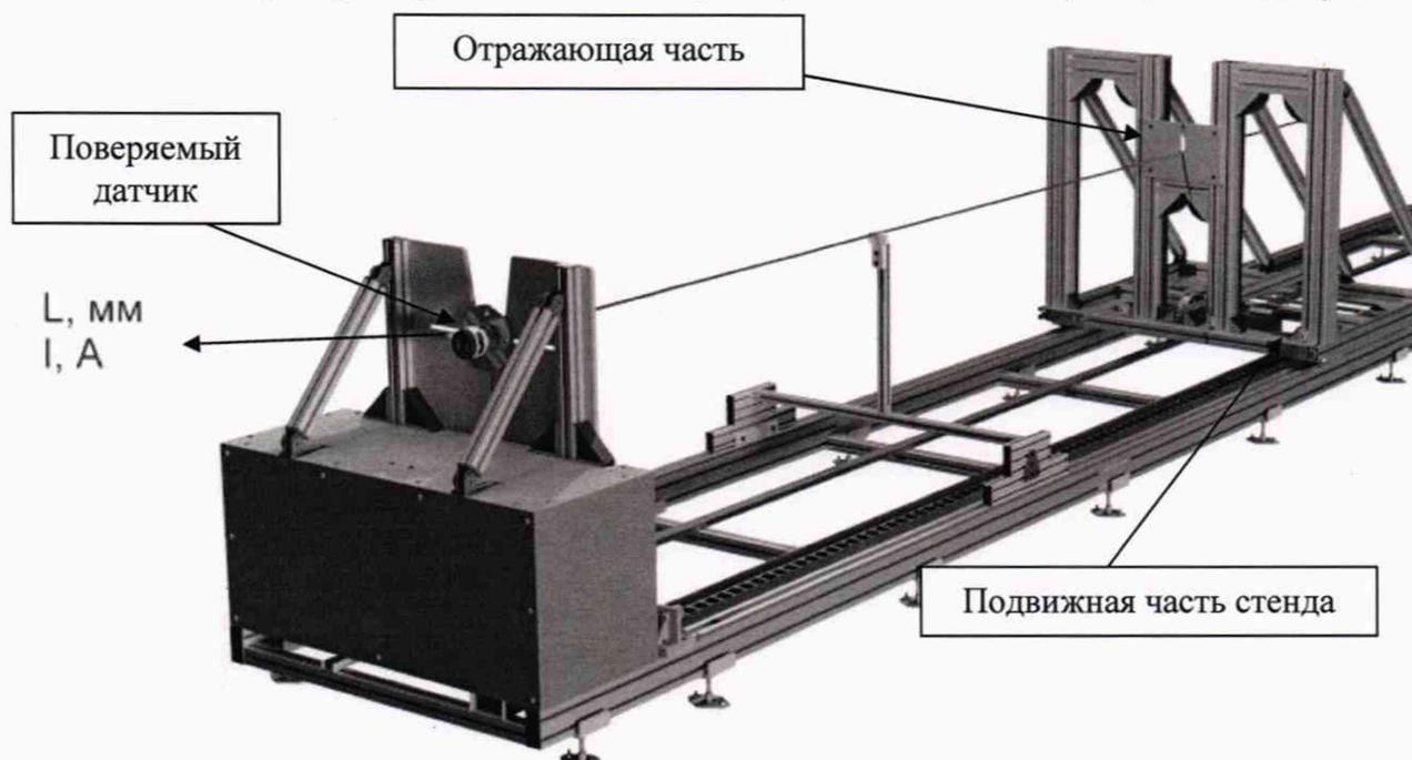
Рисунок 1 - Поверка датчика на поверочной установке с имитацией изменения уровня<sup>1)</sup>
