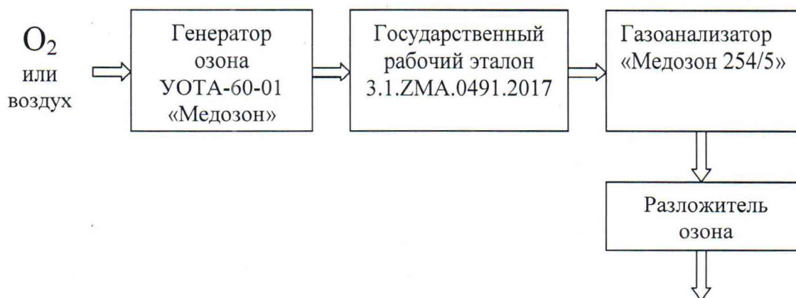
Рисунок 1 - Схема подключения газоанализатора к генератору озона и к Государственному рабочему эталону 3.1.ZMA.0491.2017
