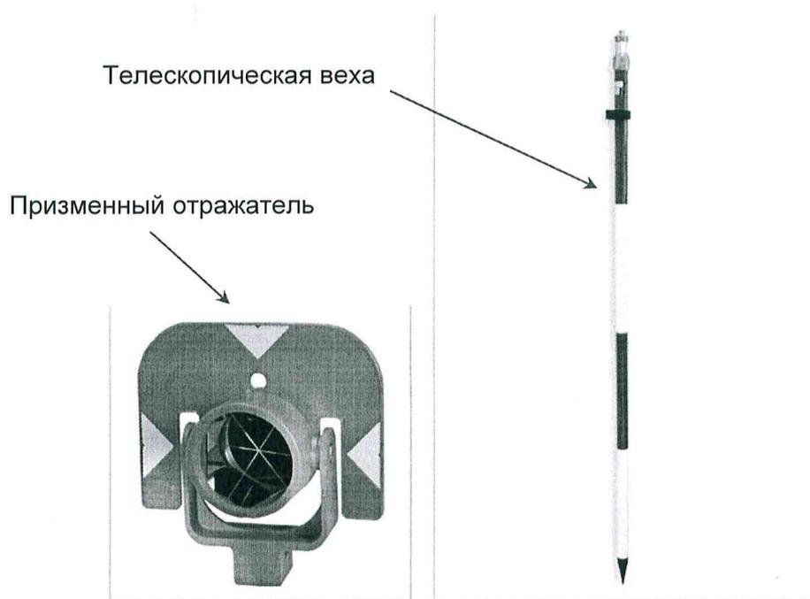
Рисунок А.1 – Веха телескопическая с призмным отражателем
