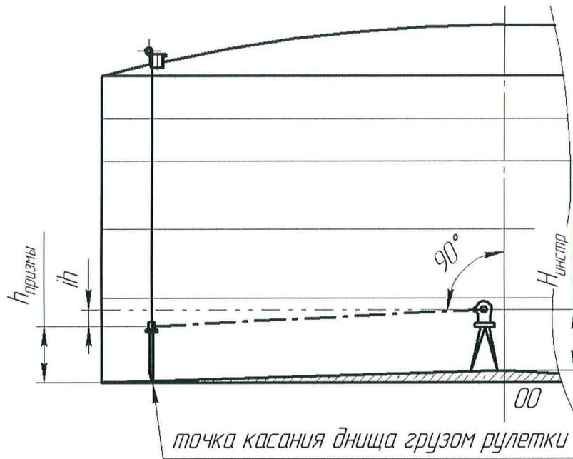
Рисунок А.8 – Схема измерений высотной привязки тахеометра
