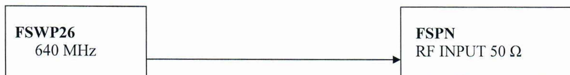
Рисунок 4 – Структурная схема соединения СИ для определения уровня собственных фазовых шумов
