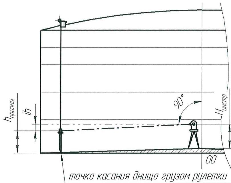
Рисунок А.8 – Схема измерений высотной привязки тахеометра
