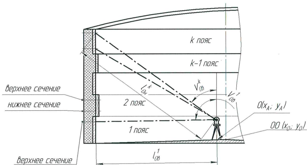
Рисунок А.5 – Схема измерений радиусов поясов резервуара
