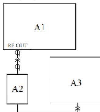
A1 – испытуемый генератор; A2 – преобразователь измерительный ваттметра;
