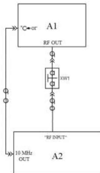
A1 – испытуемый генератор; A2 – анализатор фазового шума FSWP26;
