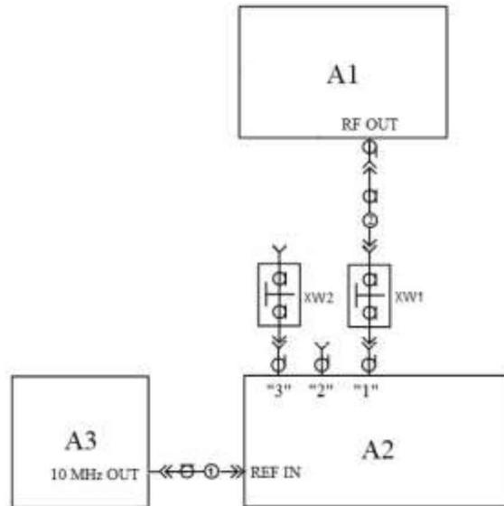
A1 – испытуемый генератор; A2 – частотомер; A3 – стандарт частоты;
