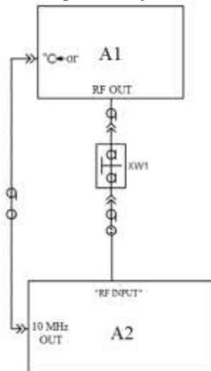
A1 – испытуемый генератор; A2 – анализатор спектра;
