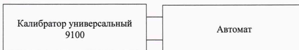
Рисунок 2 – Схема подключения для определения абсолютной основной погрешности измерений частоты переменного тока
