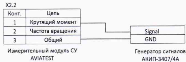
Рисунок А.3. Схема поверки вторичной части ИК переменной составляющей крутящего момента силы
