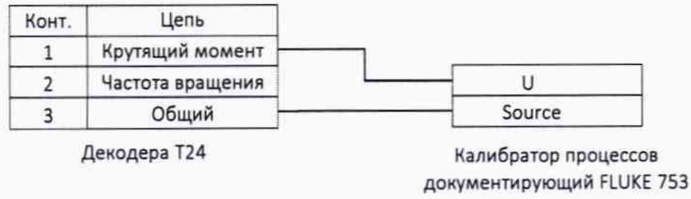
Рисунок А.1. Схема поверки первичной части ИК постоянной и переменной составляющей крутящего момента силы
