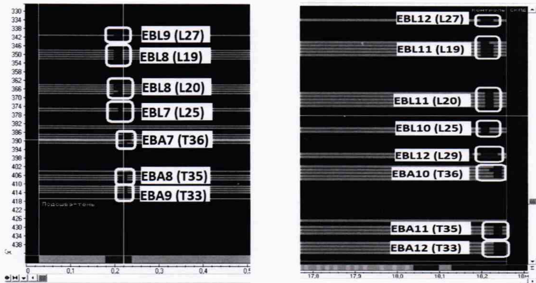
Рисунок 4 – Модели дефектов на переднем (слева) и заднем (справа) конце CO5 для датчиков L19, L20, L25, L27, L29 и T33, T35, T36
