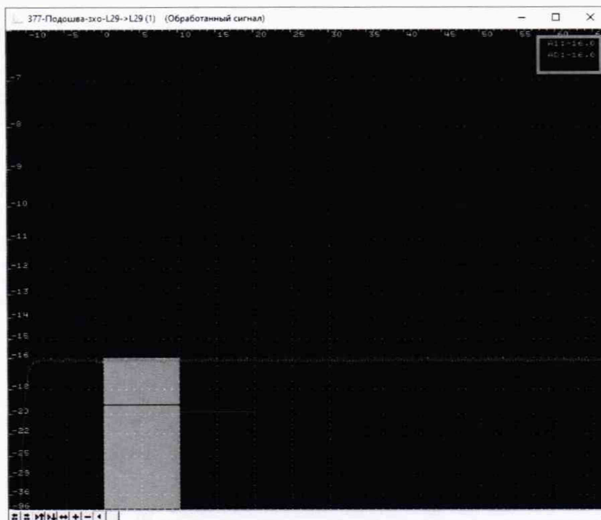
Рисунок 12 – Сигнал, поданный с генератора, на развертке первого элемента преобразователя «Т17», блока преобразователей «С3»
