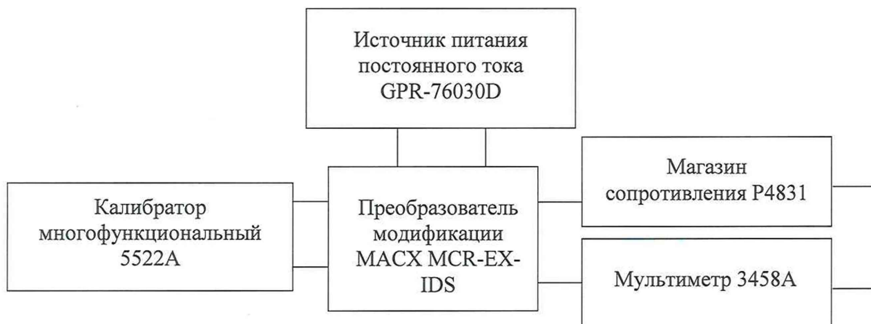
Рисунок 1 – Схема подключений для поверки преобразователя модификации MACX MCR-EX-IDS
