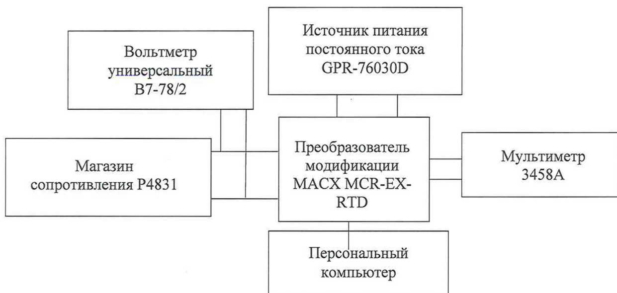
Рисунок 3 – Схема подключений для поверки преобразователя модификации MACX MCR-EX-RTD
