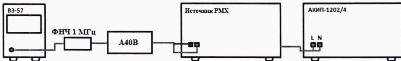
Рисунок 4 – Схема соединения приборов для определения уровня пульсаций выходного тока
