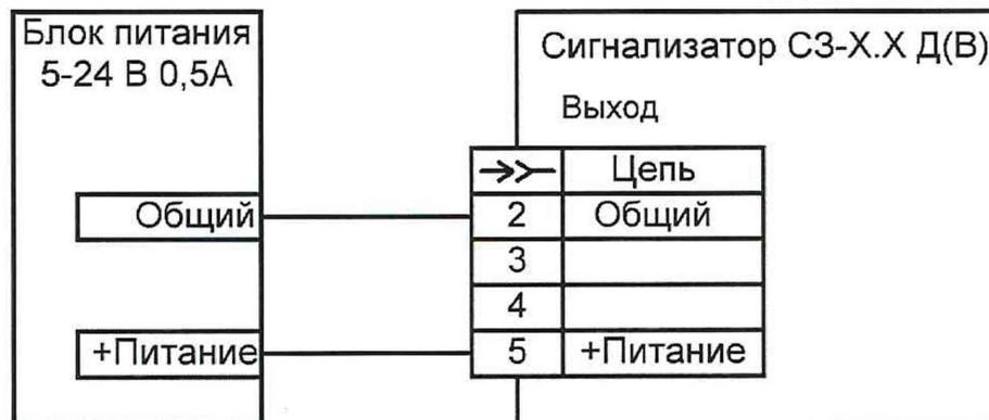
Рисунок 1 – Схема подключения сигнализатора исполнений СХ-Х.ХД(В)
