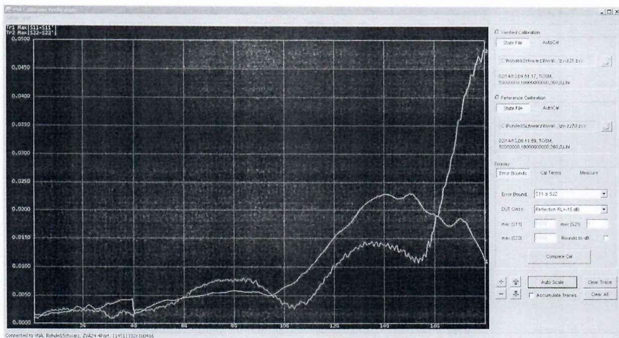
Рисунок 4 – Отображение погрешностей коэффициента отражения в ПО «CalVer»
