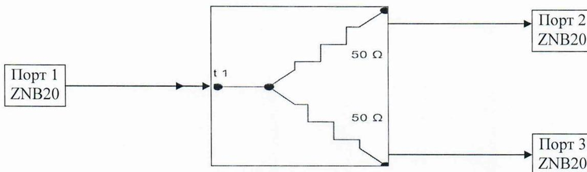
Рисунок 2– Структурная схема соединения СИ для определения коэффициента передачи резистивного делителя мощности
