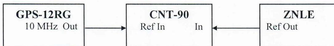
Рисунок 1 – Структурная схема соединения СИ для определения диапазона частот и относительной погрешности установки частоты опорного генератора
