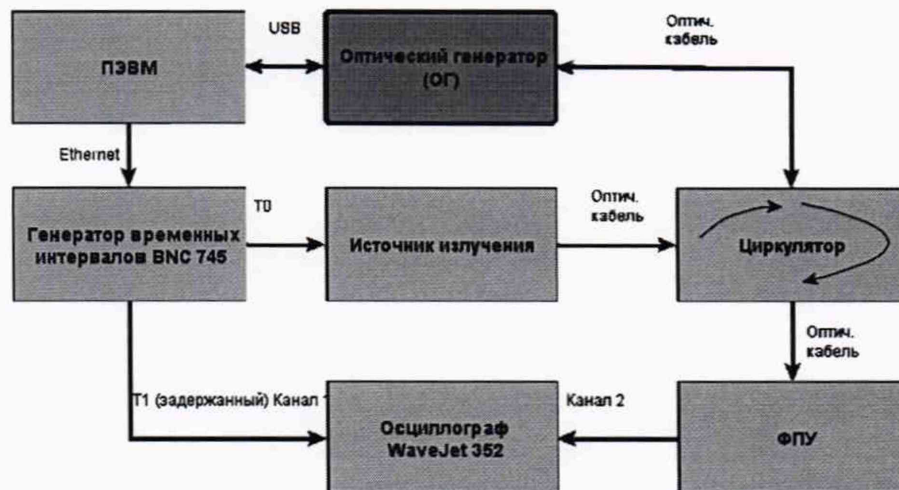
Рисунок 3 - Схема подключения приборов для измерения общей задержки
