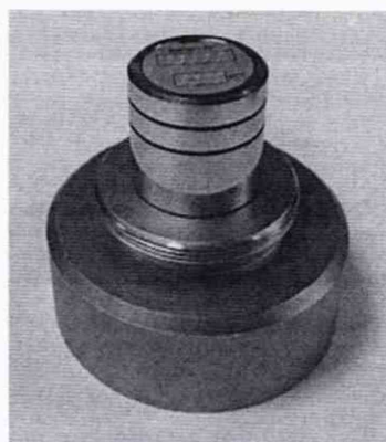
Рисунок 2 – Мера для калибровки увеличения к прибору FMS 8200
