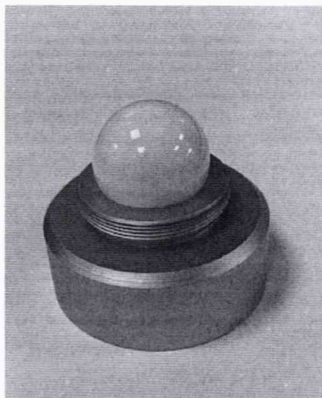
Рисунок 1 – Мера отклонения от круглости к прибору FMS 8200
