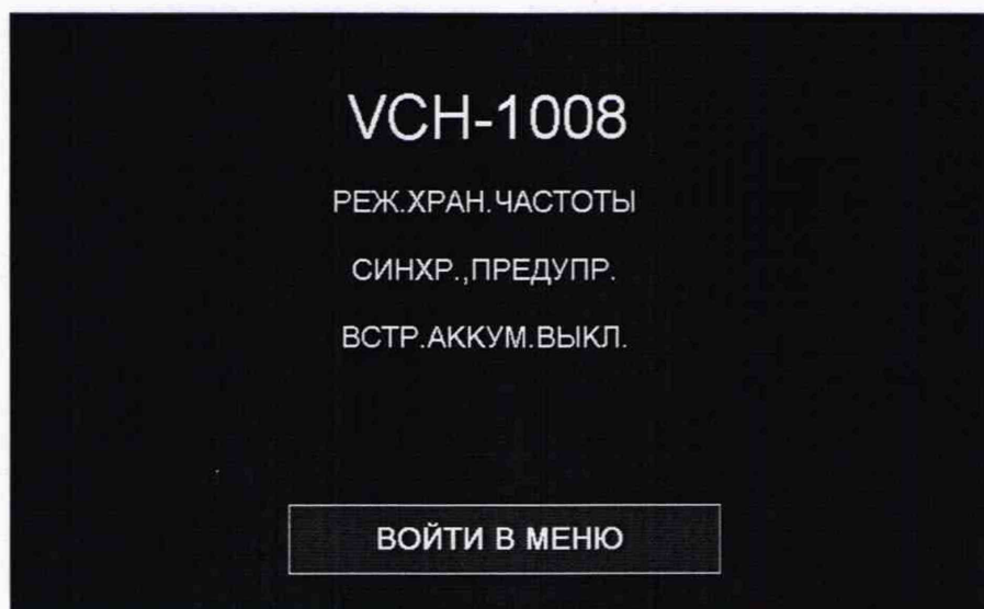
Рисунок 3 - Сообщение на экране прибора в режиме нормальной работы с предупреждениями
