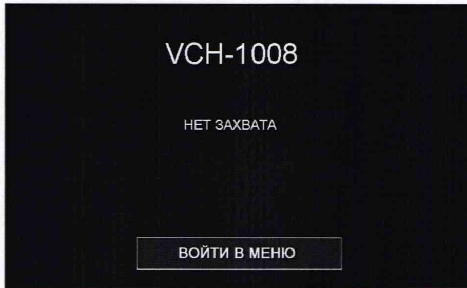
Рисунок 4 - Сообщение на экране прибора при потере синхронизации Неисправные приборы бракуются и направляются в ремонт.
