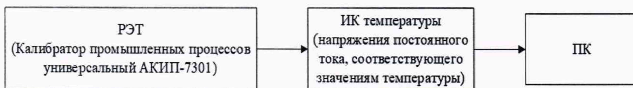
Рисунок 6 - Схема поверки ИК температуры (напряжения постоянного тока, соответствующего значениям температуры), РЭТ калибратор промышленных процессов универсальный АКПП-7301
