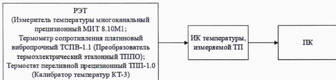
Рисунок 5 - Схема поверки ИК температуры, измеряемой ТП, РЭТ МИТ 8.10М1 с ТСПВ-1.1 (ТППО) и ТПП-1.0 (КТ-3)
