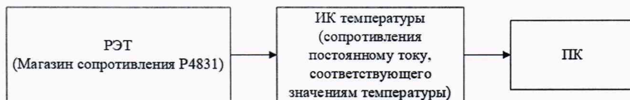
Рисунок 4 - Схема поверки ИК температуры (сопротивления постоянному току, соответствующего значениям температуры), РЭТ магазин сопротивления Р4831
