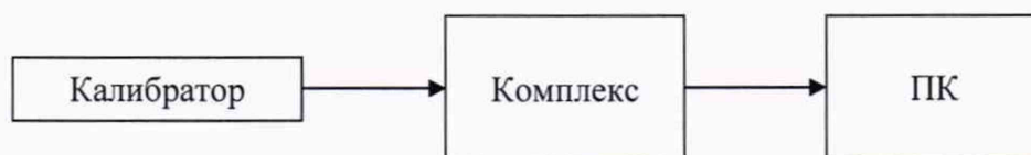
Рисунок 1 – Структурная схема при определении МХ ИК комплексов
