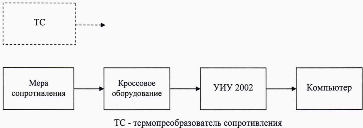
Рисунок Б.4 - Схема определения метрологических характеристик ИК сопротивления постоянному току, соответствующего значениям температуры, измеряемой термопреобразователями сопротивления по ГОСТ 6651-2009
