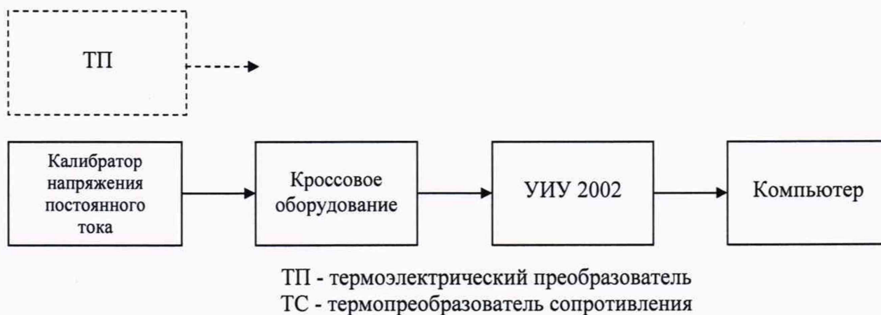
б) Схема определения метрологических характеристик с использованием калибратора напряжения постоянного тока, имеющего режим компенсации температуры «холодных спаев»
