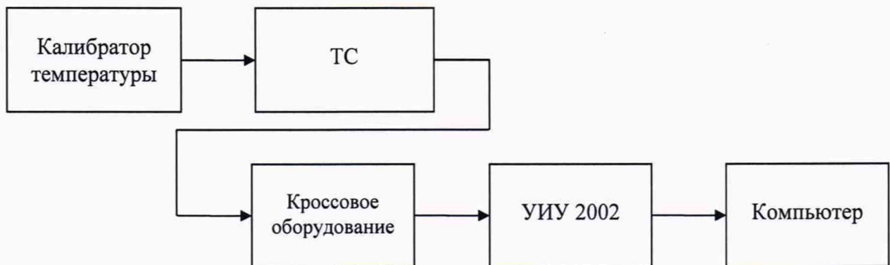
Рисунок Б.2 - Схема определения метрологических характеристик ИК напряжения постоянного тока, соответствующего значениям абсолютного давления
