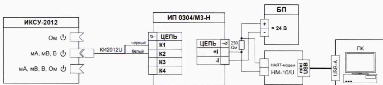
Рисунок А.8 – Схема электрическая подключений при поверке ИП (с индексом заказа С с фиксированным компенсатором холодного спая) с входными сигналами от ТП
