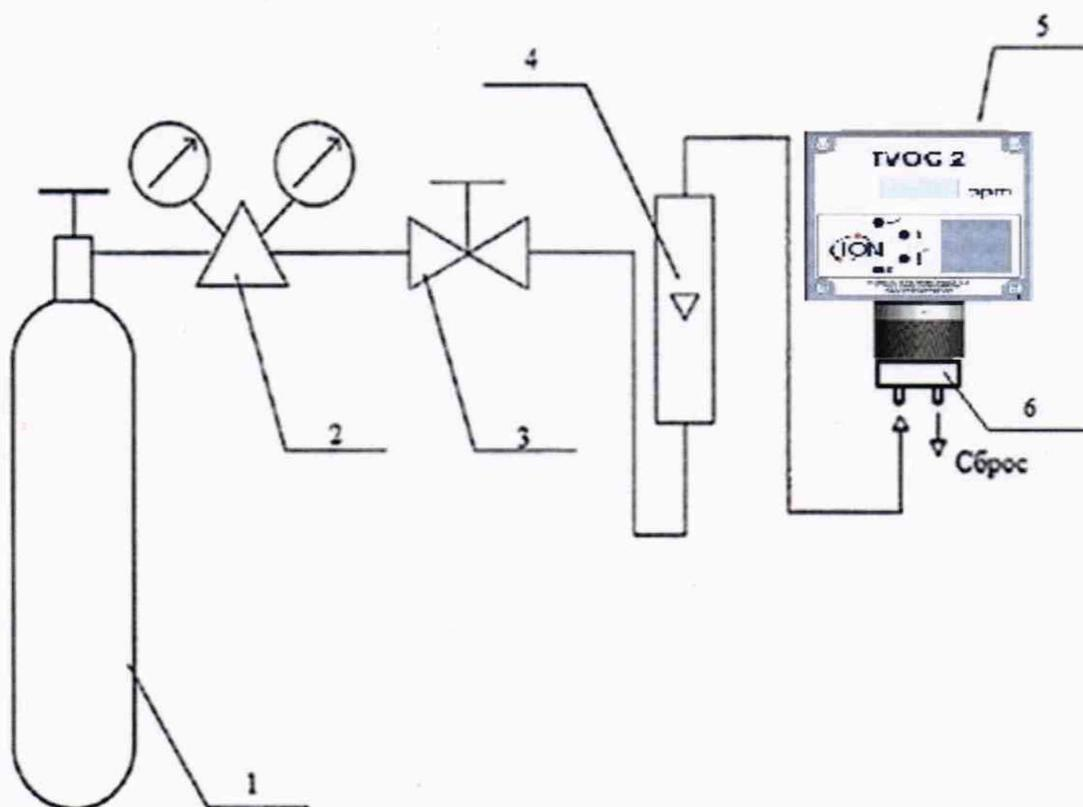
1 – источник ПГС (баллон или генератор); 2 – редуктор баллонный (только при использовании ГС в баллонах под давлением); 3 – вентиль точкой регулировки (только при использовании ПГС в баллонах под давлением); 4 – ротаметр (индикатор расхода); 5 – газоанализатор; 6 – калибровочная насадка.
