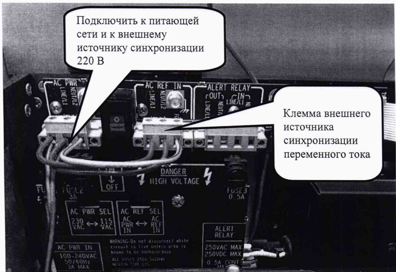
Рисунок 1 – Схема подключения системы к питающей сети (для всех модификаций)
