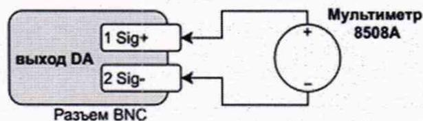
8.5 Подключение средств поверки выполнить к ИК SignalCube в соответствии со следующими схемами.
