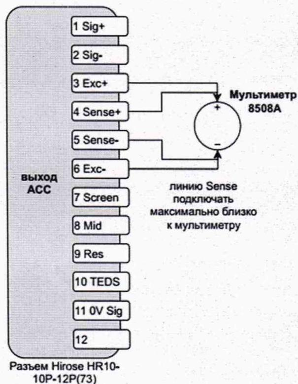
Схема подключения для проверки входного напряжения
