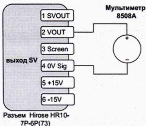
**Схема подключения для проверки входного напряжения**
