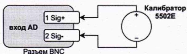
**Схема подключения для проверки входного напряжения**
