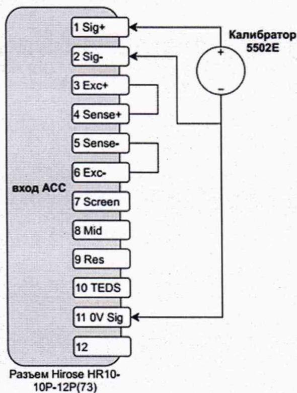
**Схема подключения для проверки питания датчиков**
