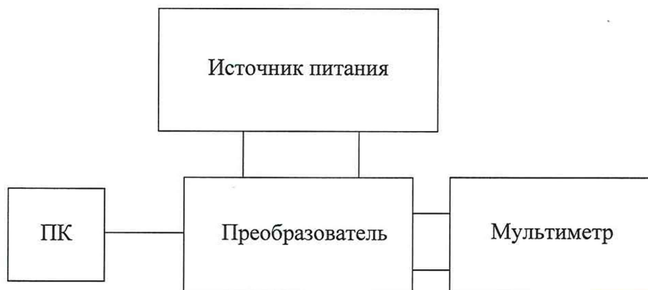
Рисунок 5 – Схема подключений для определения основной погрешности воспроизведений преобразователей модификаций 9468, 9469
