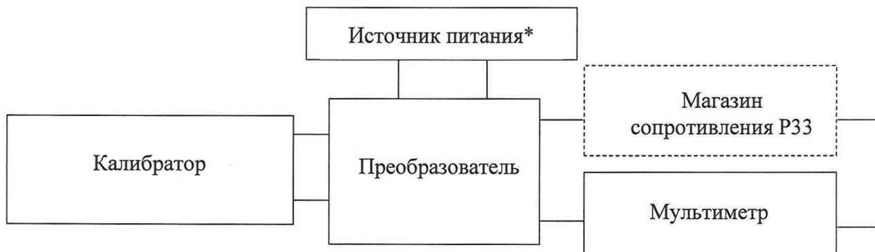
Рисунок 1 – Схема подключений для определения основной погрешности преобразователей модификаций 9147, 9160, 9162, 9164, 9165, 9167, 9260, 9265
