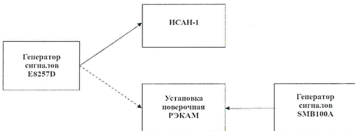
Рисунок 1 – Схема для определение погрешности измерения суммы и разности коэффициентов амплитудной модуляции (далее – АМ).
