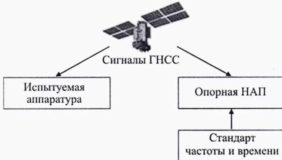
Рисунок 1 — Структурная схема проведения измерений
