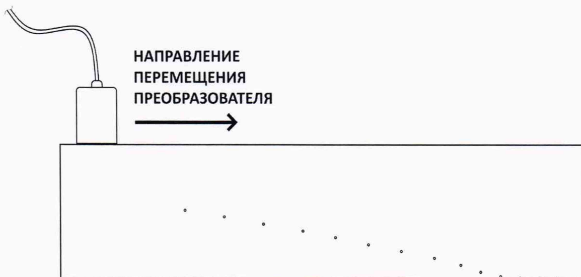
Рисунок 4 – Положение преобразователя на поверхности меры МД 2-0-1
