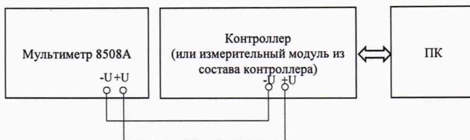
Рисунок 3 – Схема подключения при преобразовании выходного сигнала напряжения постоянного тока, силы постоянного тока
