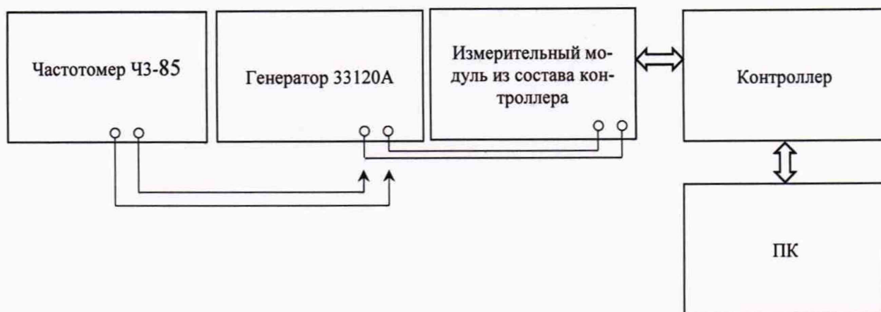
Рисунок 4 – Схема подключения при преобразовании количества импульсных сигналов
