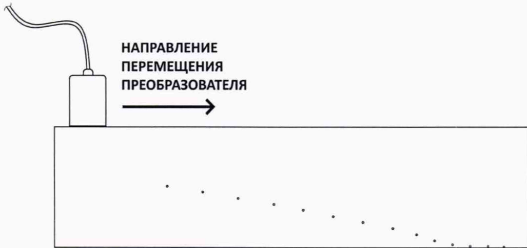
Рисунок 4 – Положение преобразователя на поверхности меры МД 2-0-1
