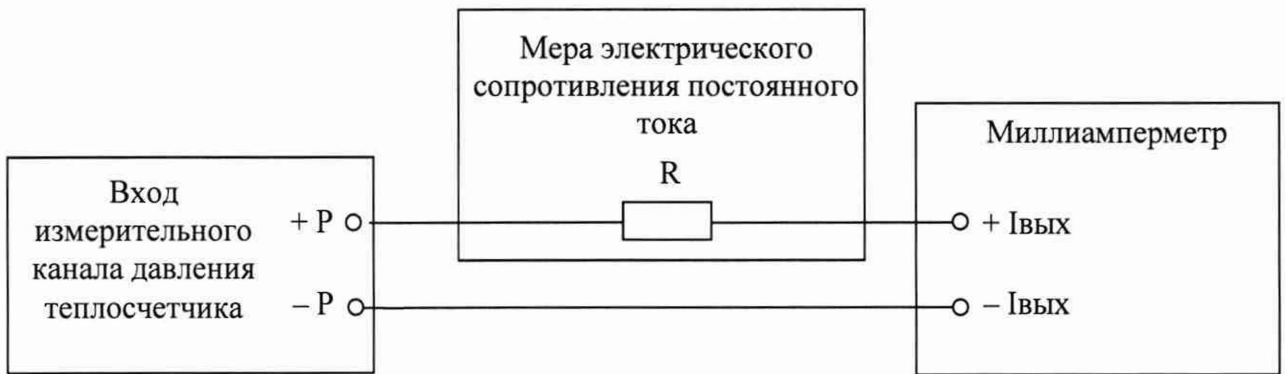
Рисунок Б.5 – Электрическая схема подключения эталонного СИ при поверке измерительного канала давления теплосчётчика при использовании меры электрического сопротивления постоянного тока и миллиамперметра
