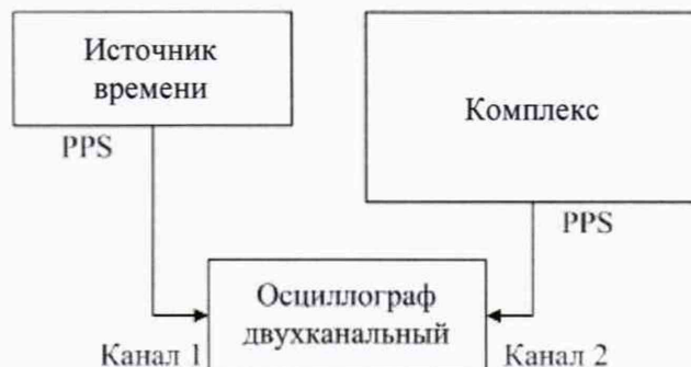
Рисунок 1 – Схема проведения измерений при определении погрешности синхронизации внутренней шкалы времени комплекса с национальной шкалой времени UTC (SU)
