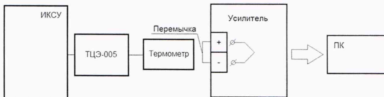
Рисунок 11 – Схема подключений при определении абсолютной погрешности компенсации температуры холодного спая
