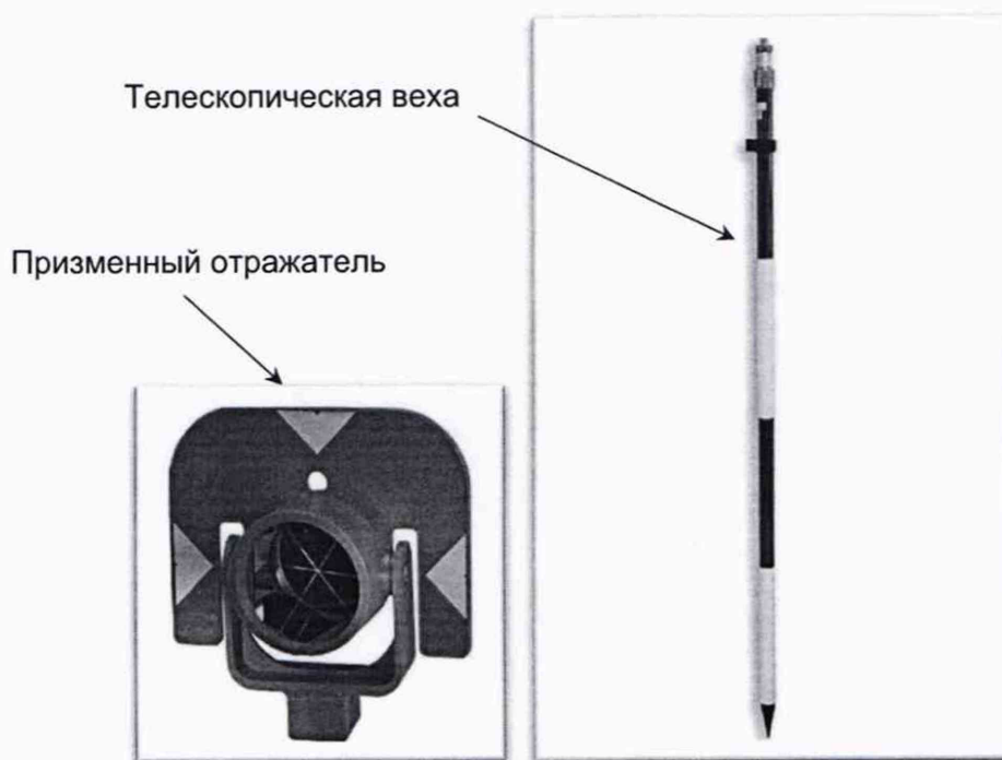
Рисунок А.1 – Веха телескопическая с призмным отражателем
